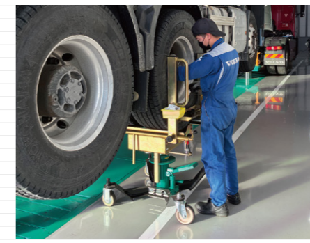
▲“タッテラーZ”を用いて大型車のダブルタイヤも立ち姿勢のまま腰に負担をかけず交換
