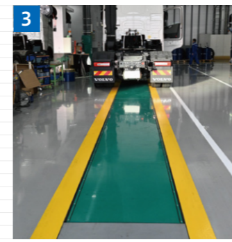
▲2分割フロアリフトは2台同時のクイック整備と重整備のいずれにも安全に対応できる
